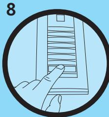
8 На вызывной панели нажмите кнопку вызова, которую хотите связать с данным абонентским устройством.
