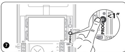
**Ingresso in Programmazione.** Premere per almeno 3 s il tasto PROG ① e rilasciarlo (entro 6 s) non appena il led PROG lampeggia e la retroilluminazione dei tasti si accende come illustrato in figura ②. La mancata accensione del Led PROG segnala un malfunzionamento. Verificare le connessioni e rientrare in programmazione.
