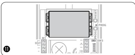
**Sair da Programação.** Prima brevemente a tecla PROG (8); o led PROG fora. NOTA. Na ausência de qualquer operação, o processo termina automaticamente após 30 minutos.
