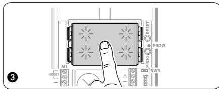
**Programmazione del Tipo dei Tasti.** Premere il primo tasto del posto esterno nella posizione indicata ③/③A finché i led della retroilluminazione smetteranno di lampeggiare ④ rimanendo accesi.
