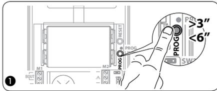
**Ingresso in Programmazione.** Premere per almeno 3 s il tasto PROG ① e rilasciarlo (entro 6 s) non appena il led PROG si accende e la retroilluminazione dei tasti lampeggia come illustrato in figura ②. La mancata accensione del Led PROG segnala un malfunzionamento. Verificare le connessioni e rientrare in programmazione.
